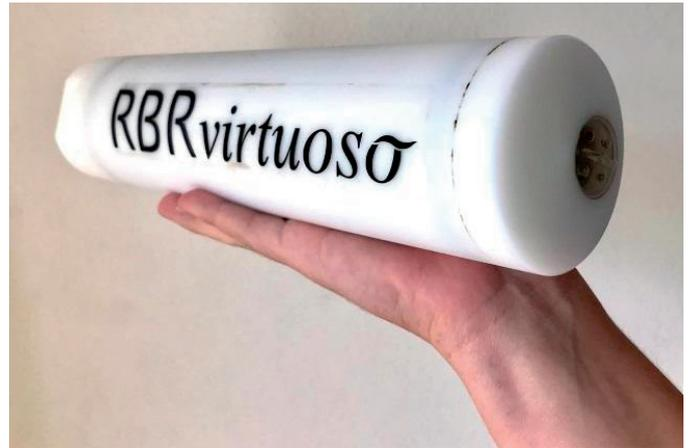
**Figura 10** – Marégrafo de pressão RBR Virtuoso.
