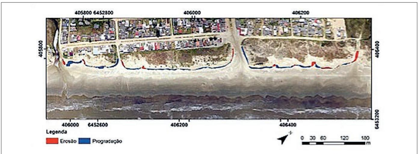
**Figura 3** – Variação do limite das dunas frontais para o período de outubro de 2016 a agosto de 2017. (Imagem: DJI Phantom – 23/11/2017)
