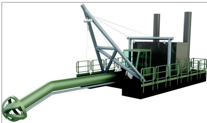
**Figura 23** – Imagem esquemática de uma draga de sucção.
