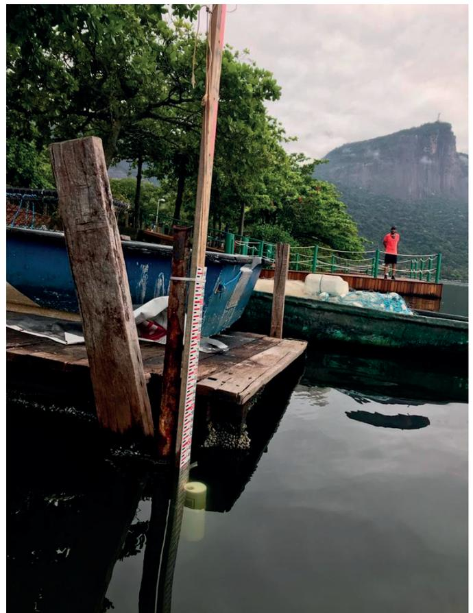
**Figura 11** – Marégrafo e régua de maré instalados no cais da Colônia de Pescadores da Lagoa Rodrigo de Freitas.
