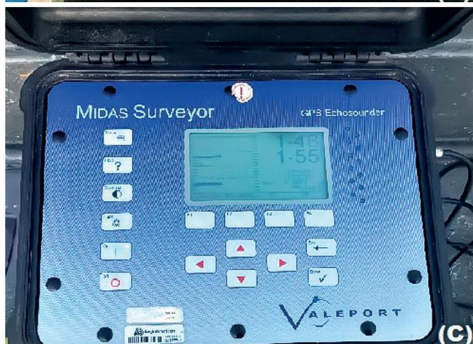
**Figura 12** – (A) Ecobatímetro monofeixe de dupla frequência Midas Surveyor - Valeport. (B) Transdutor do ecobatímetro Midas Surveyor - Valeport. (C) Painel do ecobatímetro Midas Surveyor Valeport.
