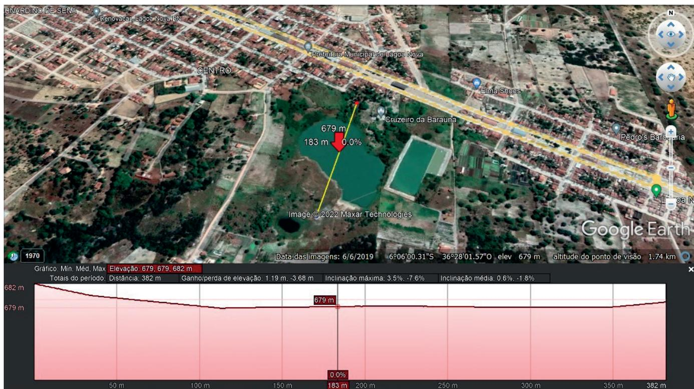
**Figura 2** – Esquema geral do escoamento superficial das águas pluviais na área urbana de Lagoa Nova.
