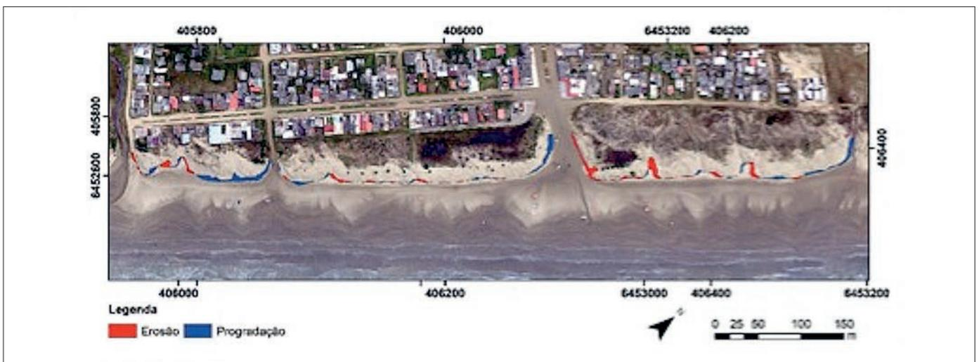
**Figura 4** – Variação do limite das dunas frontais para o período de agosto de 2017 a dezembro de 2018. (Imagem: DJI Phantom – 15/07/2018)
