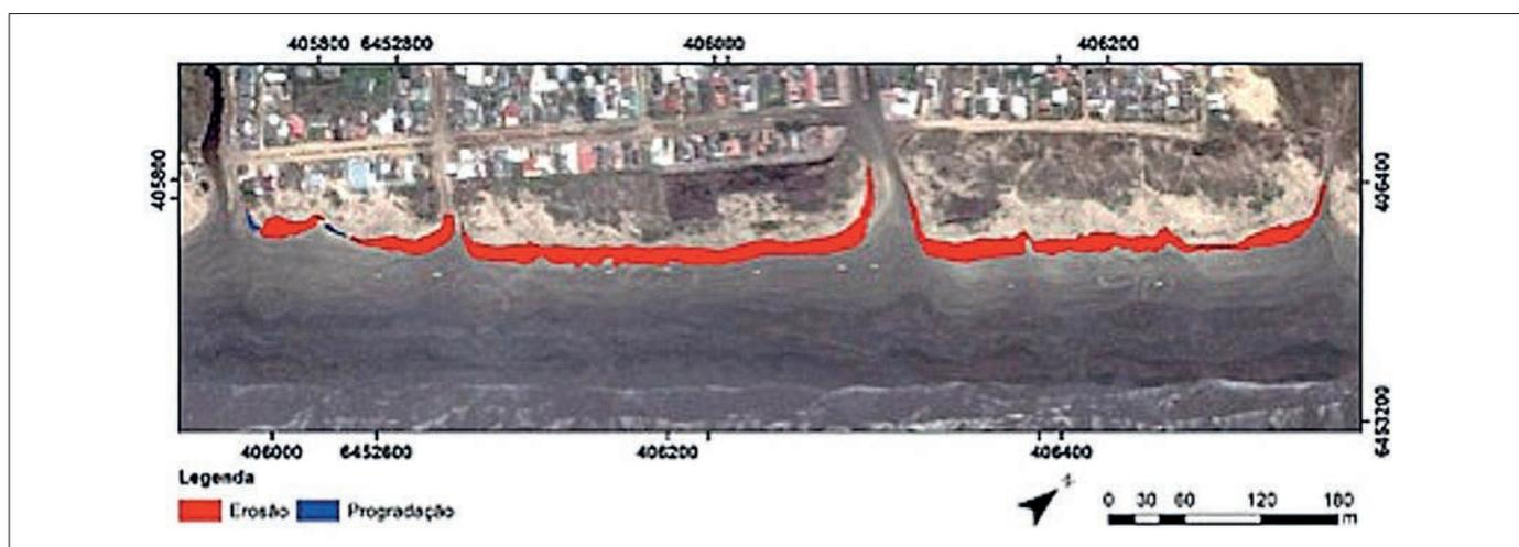
**Figura 2** – Variação do limite das dunas frontais para o período de junho de 2015 a outubro de 2016. (Imagem: Repositório do *Google Earth Pro* – 30/10/2016)
